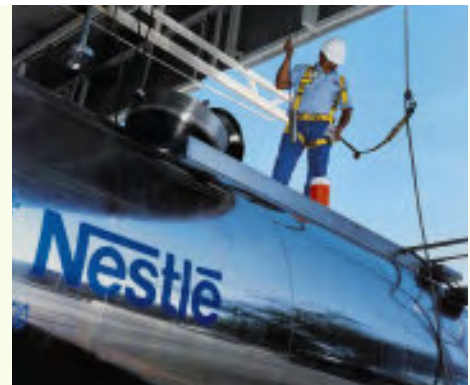
Sicherheit am Arbeitsplatz: Ein Arbeiter in Mexiko, trägt einen Sicherheitsgurt bei der Inspektion und Reinigung eines Milchtankers
